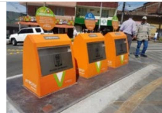
En **Barranquilla** instaló 4 sistemas que contienen 3 contenedores de 1.100 litros. El sistema está hecho en acero inoxidable, las contenedoras que van por dentro son de polietileno de alta densidad, que es un material reciclable y se puede usar nuevamente una vez la vida útil expire. 14-07-2017
